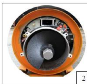
Figure 2.15 : Arrière du microtunnelier (2)
